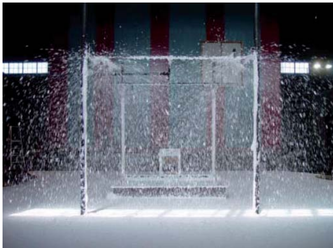
Figura 14: Descarga de Espuma por Aire Comprimido desde un Sistema de Tubería Fija. Foto Cortesía de Fireflex Systems INC.
