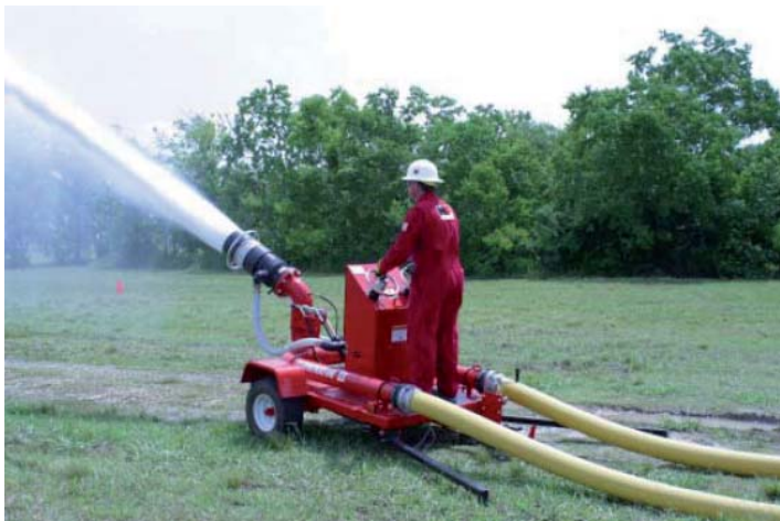
Figura 4: Ejemplo de Sistema Móvil de Espuma. Foto Cortesía: Kidde Fire Fighting
