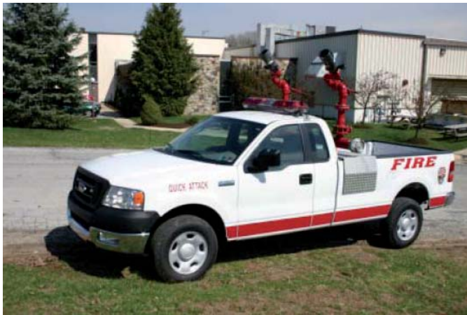
Figura 2: Ejemplo de Sistema Móvil de Espuma. Foto Cortesía: Kidde Fire Fighting
