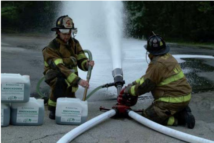
Figura 5: Ejemplo de Sistema Portátil de Espuma. Foto Cortesía: Kidde Fire Fighting
